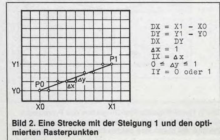
Bild 2. Eine Strecke mit der Steigung 1 und den optimierten Rasterpunkten
